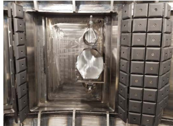
Рис. 6. Система ввода СВЧ-излучения, установленная внутри вакуумной камеры Т-15МД
