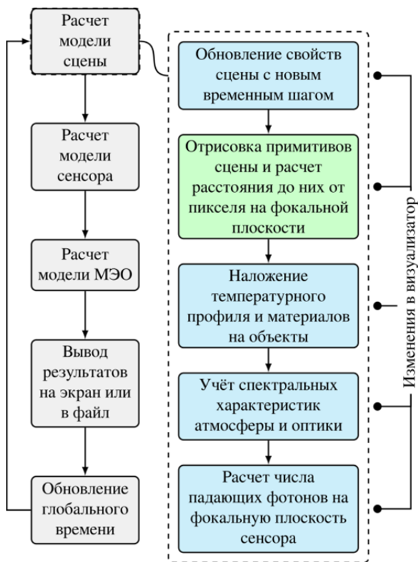
Рис. 1. Диаграмма активности основного цикла работы визуализатора с подробным описанием действий в рамках модуля «Сцена»
