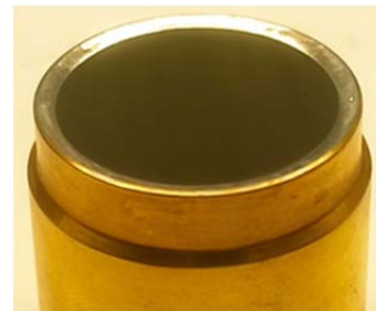
Рис. 6. Фрагмент металлического корпуса фотоприемника с впаянным входным окном
