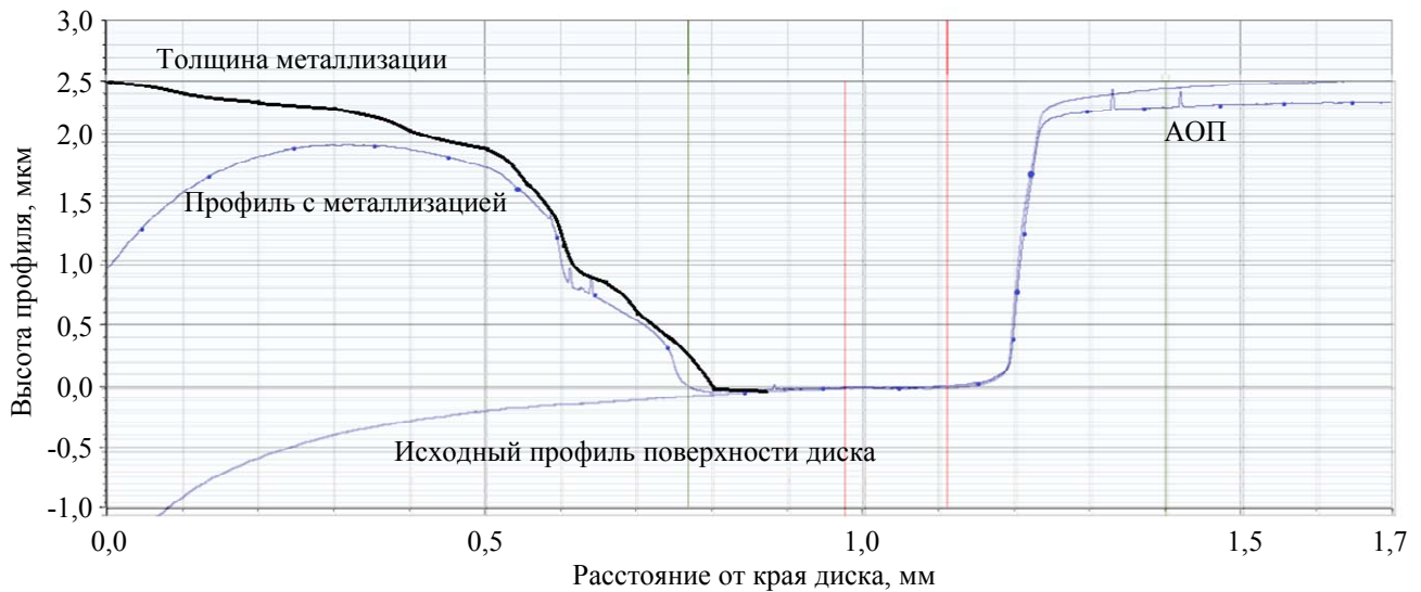
Рис. 3. Профили на поверхности края Ge диска до и после напыления в загрузочном устройстве с маскирующим элементом, касающимся поверхности оптически прозрачного элемента с АОП, высотой 100 мкм и игольчатым сепаратором
