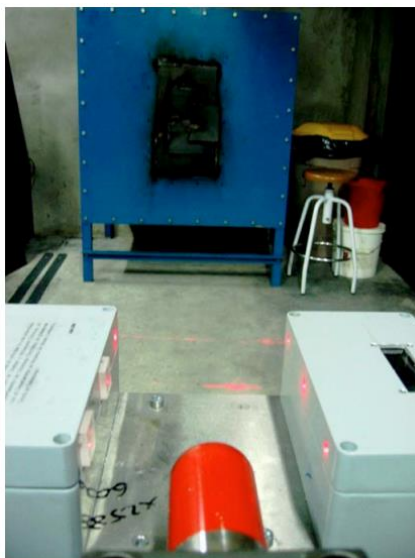
Рис. 1. Оптическая система контроля: а) – схема эксперимента: 1 – инжектор микрочастиц, 2 – лазеры, 3 – фотодиоды; б) – фотография установки [17]
