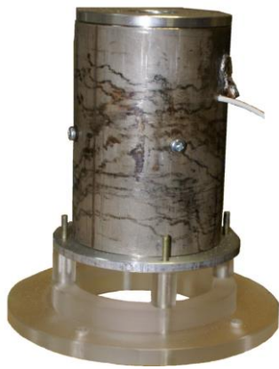
Рис. 13. Конструкция измерительной линейки из цилиндрических электродов
