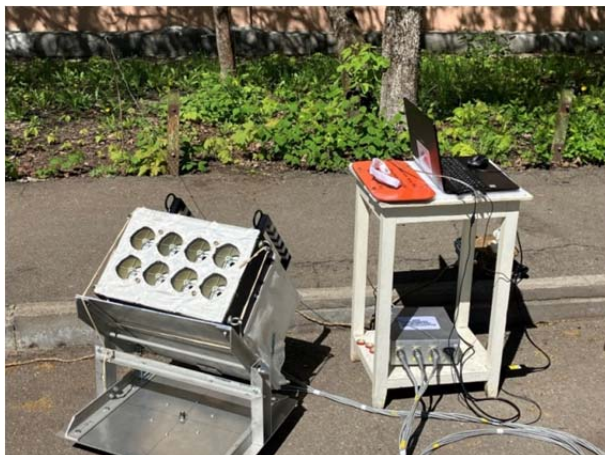
Рис. 3. Измерение солнечного излучения научной аппаратурой на Долгопрудненской научной станции ФИАН
