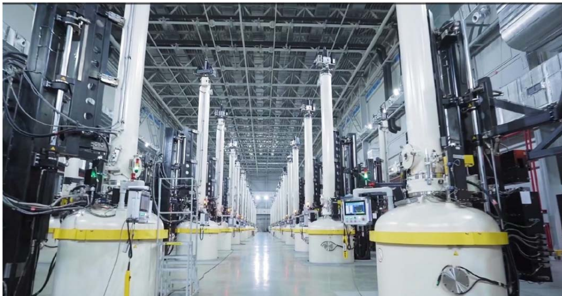
Рис. 6. Зал установок для выращивания монокристаллического кремния методом Чохральского на производстве в Черняховске
