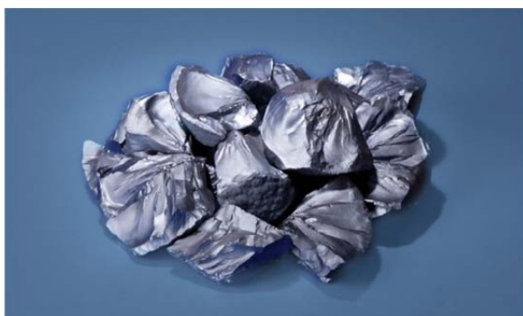
Рис. 5. Внешний вид ПКК – по Сименс-процессу и гранулированного
