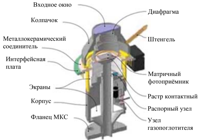
Рис. 1. Конструкция фотоприёмного устройства
