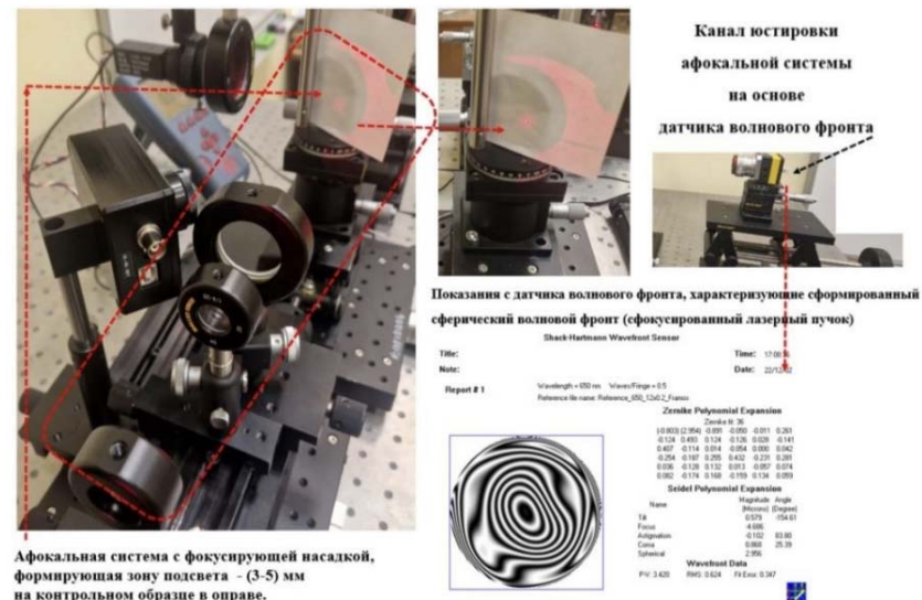
Рис. 7. Технологический этап юстировки афокальной оптической системы с фокусирующей насадкой канала подсвета макетного образца по выходным данным датчика волнового фронта
