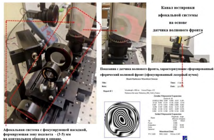
Рис. 7. Технологический этап юстировки афокальной оптической системы с фокусирующей насадкой канала подсвета макетного образца по выходным данным датчика волнового фронта
