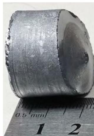
Рис. 4. Фотография образца полученного кремния
