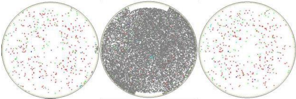
Рис. 6. Фотографии пластин из германия, на разных стадиях производства, созданных и подготовленных компанией Umicore, и исследованные с помощью прибора KLA-Tencor Candela: чистая, загрязненная и повторно очищенная пластина (слева направо)
