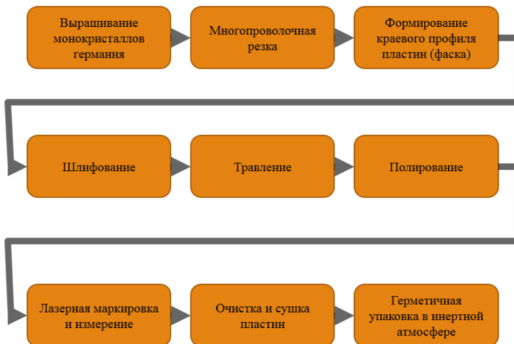
Рис. 5. Технологический маршрут производства подложек в АО «Германий», предназначенных для проведения эпитаксиальных процессов при создании фотоэлектрических преобразователей GaInP/GaAs/Ge
