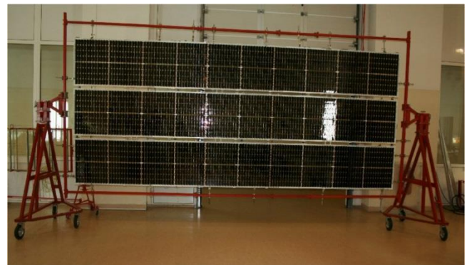
Рис. 7. Произведенные в России солнечные батареи с полупроводниковыми каскадными фотоэлектрическими преобразователями на основе соединений A_3B_5/Ge . Рабочая поверхность \sim 10 \text{ м}^2
