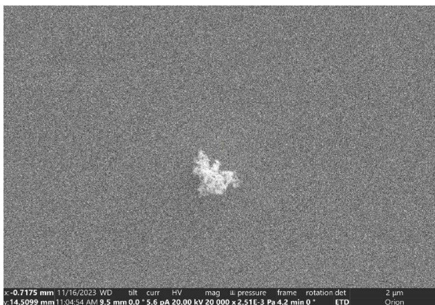
Рис. 15. Примеры загрязнений, обнаруженные на пластинах Ge, при исследовании с помощью сканирующего электронного микроскопа
