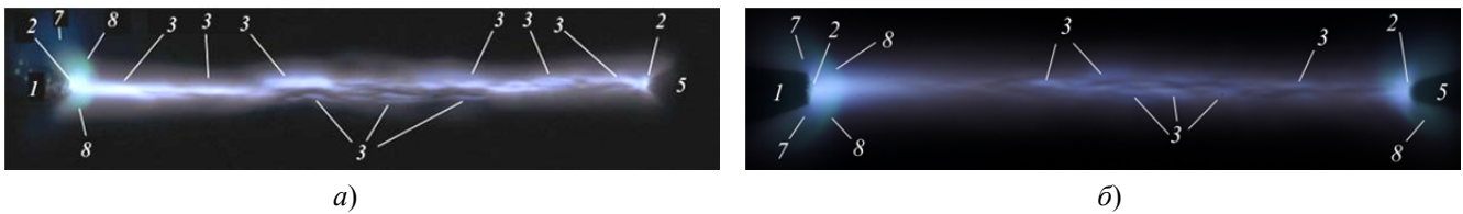
Рис. 5. Время-интегральные изображения разряда после коррекции уровней яркости и контраста (а) и без коррекции (б), полученные при давлении воздуха p = 760 Торр. Амплитуда импульса напряжения в падающей волне U_0 = 6 (а) и 16 кВ (б) от генератора положительной полярности ГИН-50-1. ISO равно 200 (а) и 100 (б). 1 – заземлённый электрод, 2 – яркие белые пятна на электродах, 3 – филаменты белого цвета, 5 – высоковольтный электрод, 7 – голубое свечение паров железа, 8 – свечение паров металла с зелёным оттенком. Y \approx 25\% , T = 23 °С. Режим однократных импульсов
